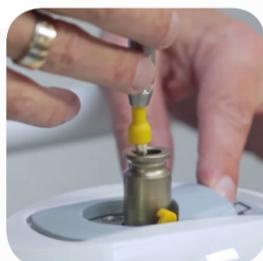
Vérrouiller le cran de sécurité (sur le moteur) afin de préparer la montée du moteur.
